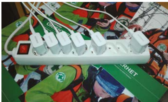
Små-elektrisk utstyr har blitt kompakt og smått de siste årene, men det trengs likevel kjøling. Står de samlet som vist her, øker temperaturen betydelig. Foto: Peter Harholt
