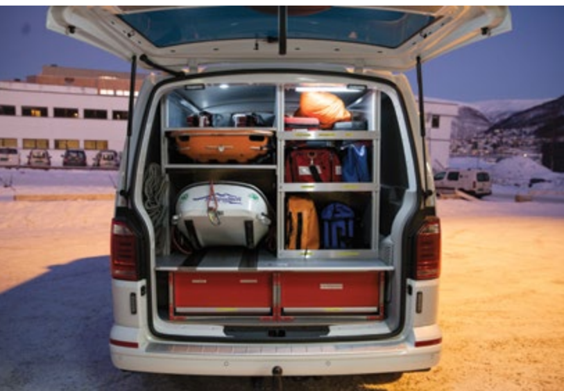
Et spesialbygget system skal sørge for at mannskapene finner det nødvendige utstyret så raskt som mulig. Bak ligger vinterutstyr og førstehjelpsutstyr diagonalt. Foto: Ida Kroksæter
